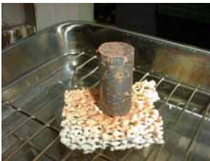
大気冷却後 皮膜剥離
